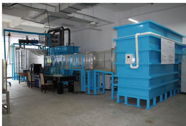
图2 天津大学流体力学实验室重力溢流式低湍流度循环水洞
