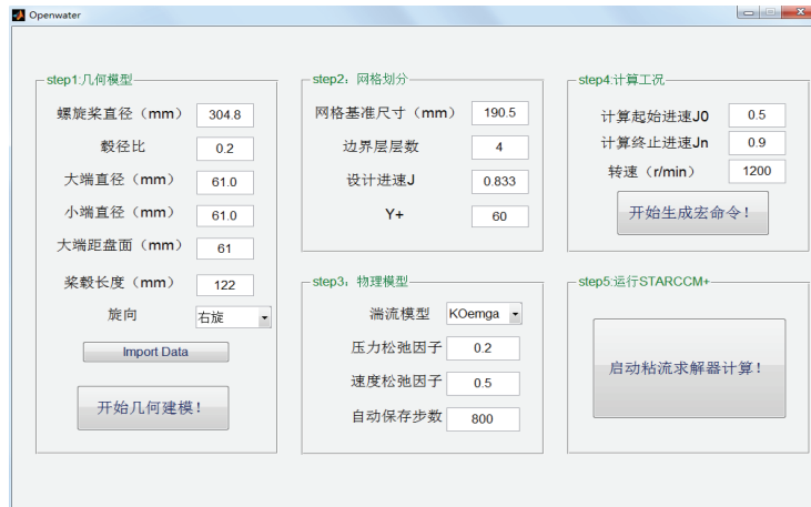
图4 螺旋桨水动力性能预报自动化程序操作界面
