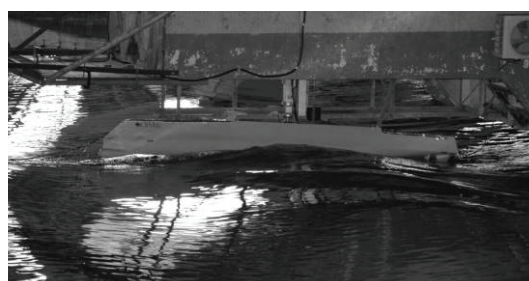
图 1 内倾船复原力试验照片
