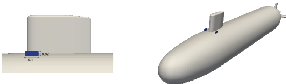
图6 指挥台围壳侧面处增加挡板和整体模型
