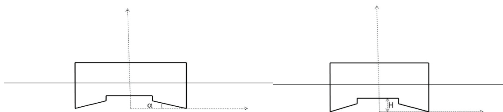
图 4 滑行艇片体底部倾斜角及槽道高度示意图
