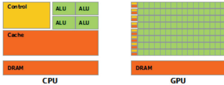
图 1 GPU 与 CPU 结构对比
