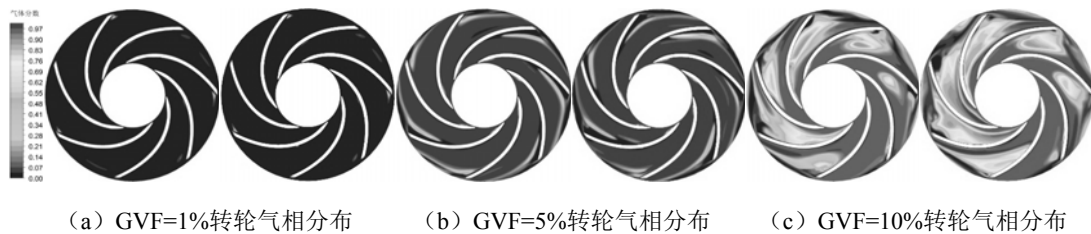
图6 三级泵首级和单级泵转轮气相分布对比图
